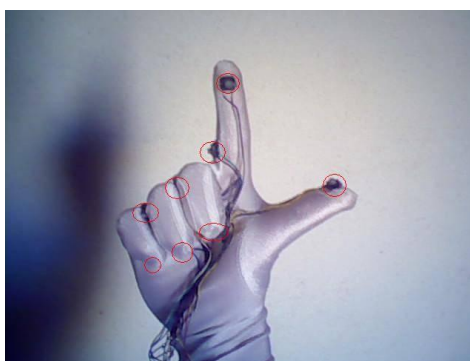
Figura 2: Luva utilizada como dispositivo de entrada de informações pelo software conectada ao computador através da porta paralela.
